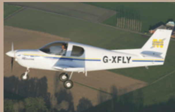
Het hoofdlandingsgestel van G-XFLY is uit veerstaal gemaakt, precies zoals bij de éénmotorige Cessna's het geval is. Wielkappen zijn gepland voor de nabije toekomst.
