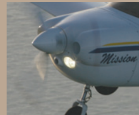
Het landingslicht blijft tijdens de vlucht van de M212 op staan. De Xe-lamp loopt niet warm, verbruikt heel weinig en schijnt vier maal sterker dan een 100W landingslicht.
