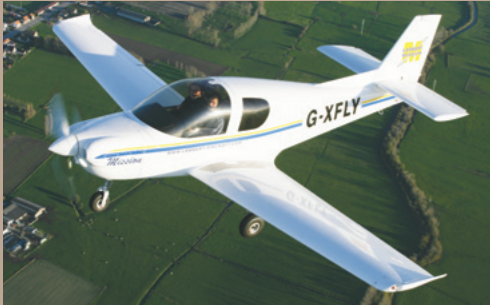
De Lambert M212 vliegt op een bijzonder mooie, maar vooral efficiënte vleugel. Het vliegtuig zal zich bijgevolg gedurende het gehele afscheurgedrag netjes blijven gedragen en nooit de wens uiten om over de ene of de andere vleugel te vallen; het begin van een te pareren tolvlucht.
