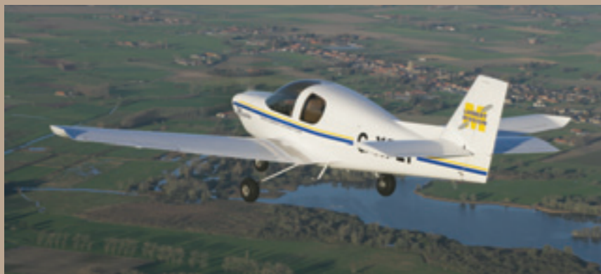
Het grote staartstuk staat garant voor een verdoorgedreven behoud van controle gedurende elke fase van de vlucht. Het hoogteroer zit halfweg en het richtingsroer is groter dan noodzakelijk, alweer voor het extreme behoud van vliegcontrole. Het staartstuk beweegt in zijn geheel.
