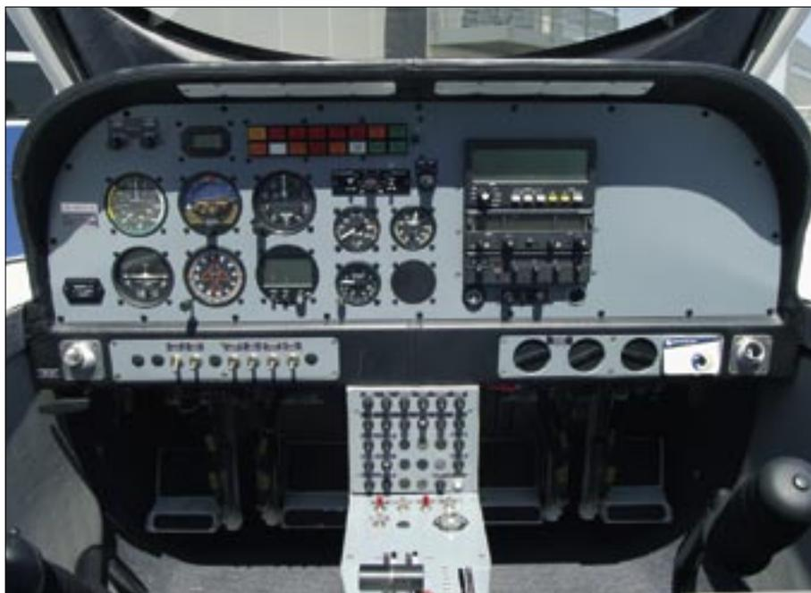
L'équipement de l'avion de démonstration est traditionnel, pour ne pas dire basique. Néanmoins la surface importante de la planche de bord permettra l'installation d'une avionique moderne et très complète, y compris des écrans multifonctions. Notez sous le panneau d'alarme la présence du potentiomètre de réglage du pas d'hélice.
